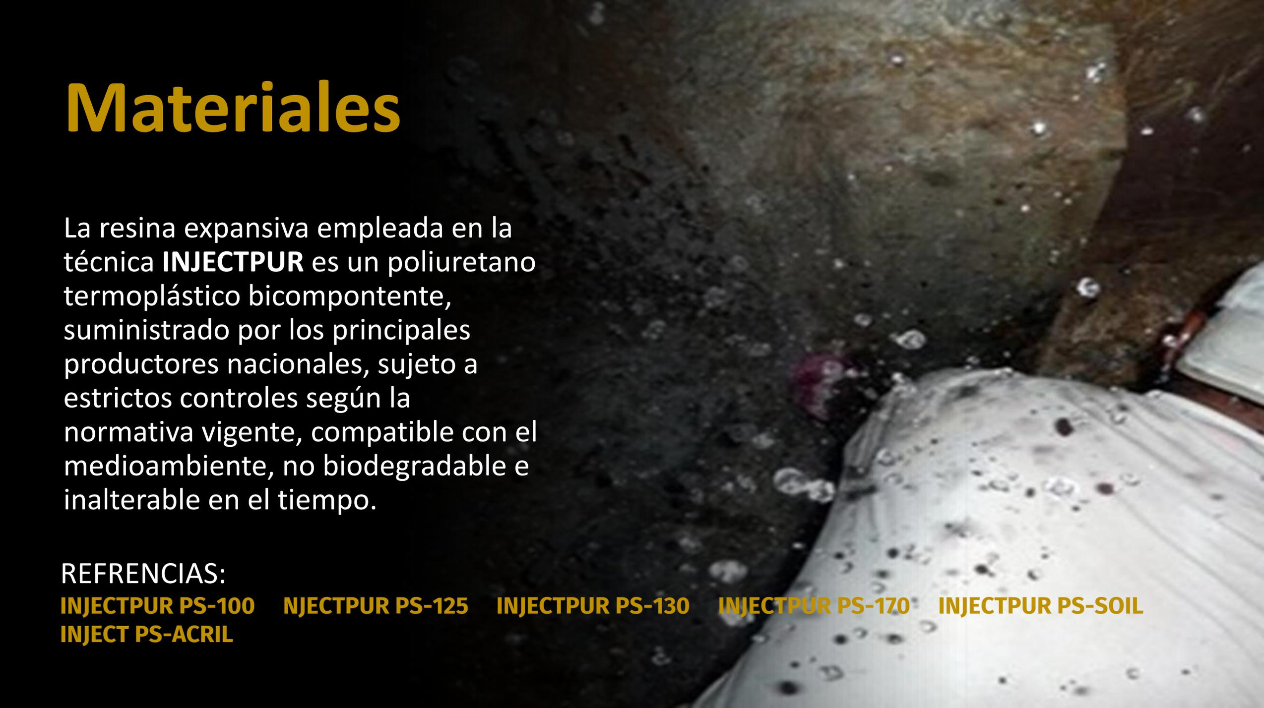
La resina expansiva empleada en la técnica **INJECTPUR** es un poliuretano termoplástico bicomponente, suministrado por los principales productores nacionales, sujeto a estrictos controles según la normativa vigente, compatible con el medioambiente, no biodegradable e inalterable en el tiempo.
