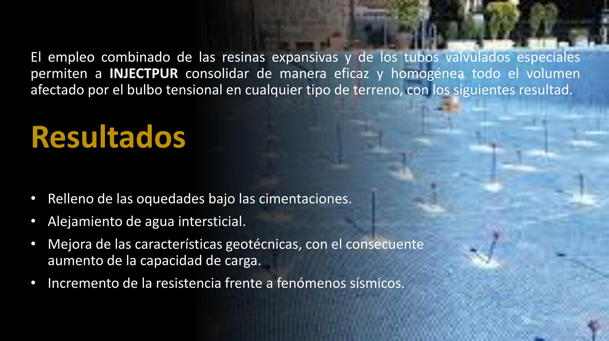
El empleo combinado de las resinas expansivas y de los tubos valvulados especiales permiten a **INJECTPUR** consolidar de manera eficaz y homogénea todo el volumen afectado por el bulbo tensional en cualquier tipo de terreno, con los siguientes resultados.
